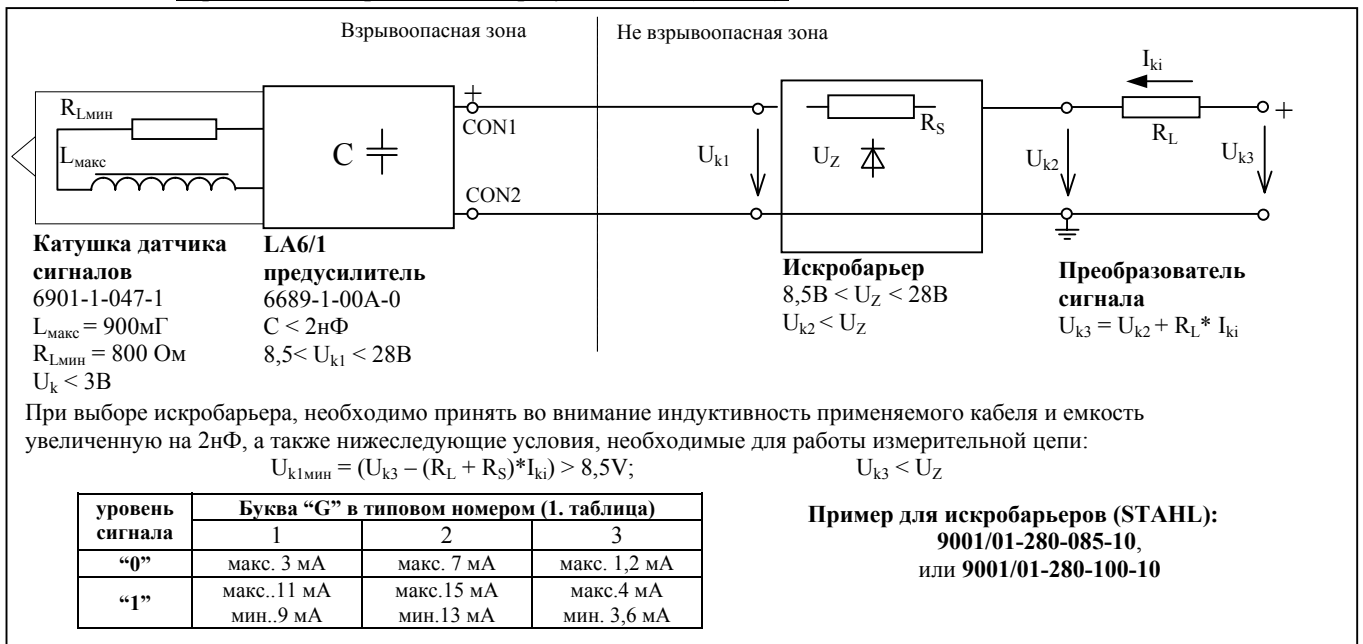
Рис. 10 Взрывоопасное применение с предуслителем (G=1,2,3).
